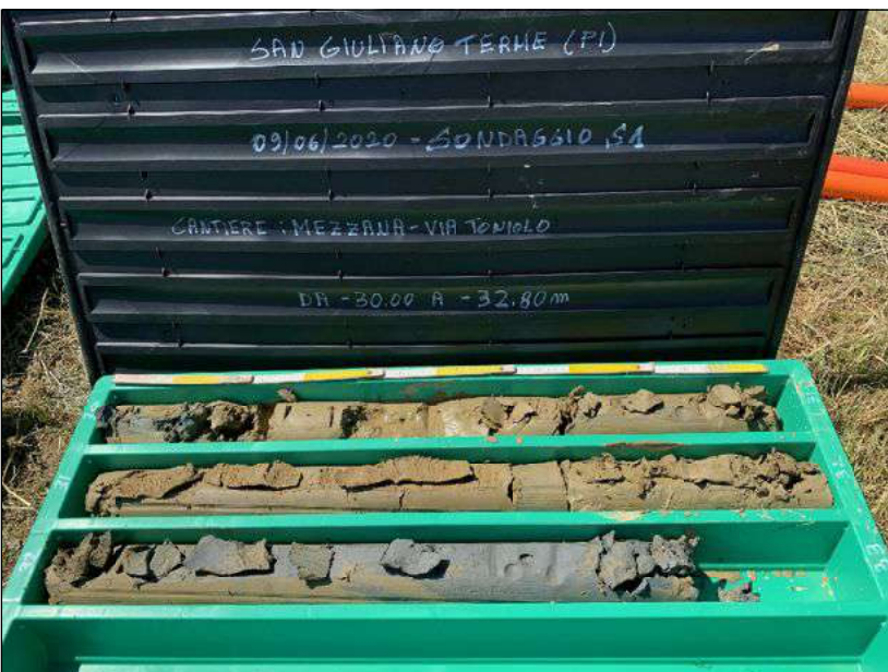
Foto n.7 : Cassetta n.7 sondaggio S1. Carote di terreno da -30.00 a -32.80 m
