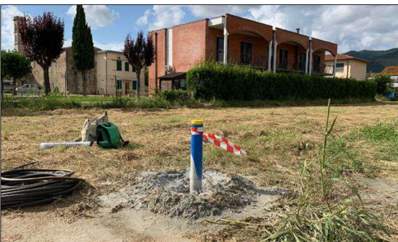
Foto n.10 : Tubazione cementata per la prova sismica Down Hole. Lunghezza 33 m, di cui 1 m fuori terra.
