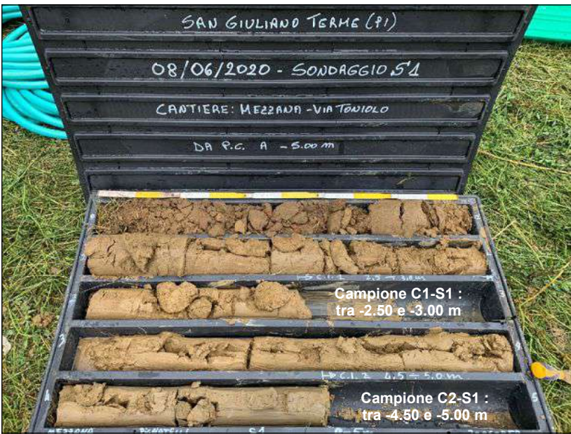
Foto n.1 : Cassetta n.1 sondaggio S1. Carote di terreno da p.c. (0.00 m) a -5.00 m
