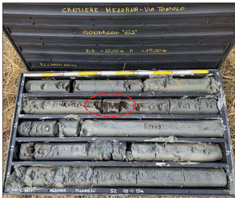
Foto n.3 : Cassetta n.3 sondaggio S2. Carote di terreno da -10.00 a -15.00 m. Cerchiato in rosso orizzonte di materia organica/torbosa fibrosa/spugnosa nerastra-bruna.
