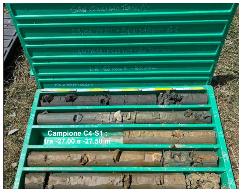
Foto n.6 : Cassetta n.6 sondaggio S1. Carote di terreno da -25.00 a -30.00 m
