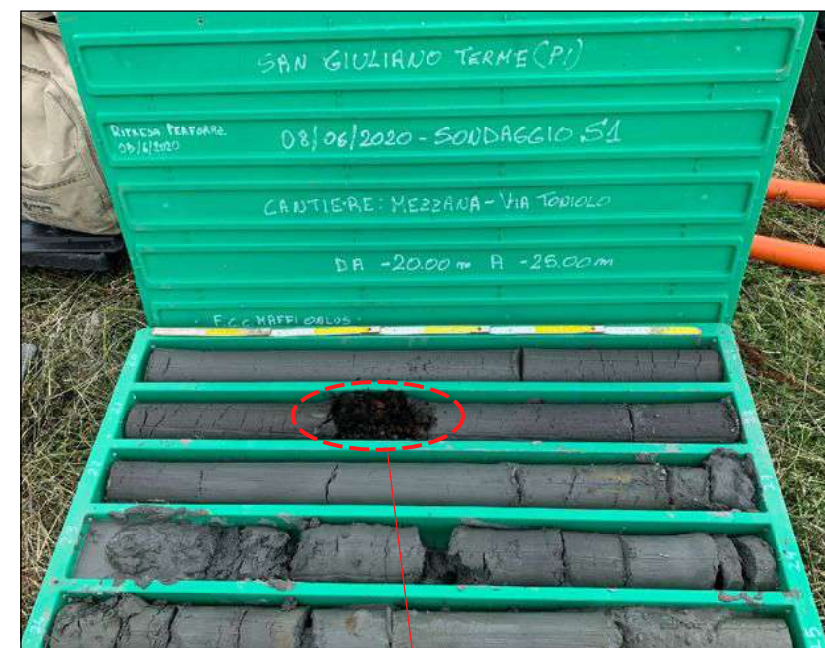
Foto n.5 : Cassetta n.5 sondaggio S1. Carote di terreno da -20.00 a -25.00 m. Cerchiato in rosso orizzonte di materia torbosa fibrosa/spugnosa bruno-nerastra.
