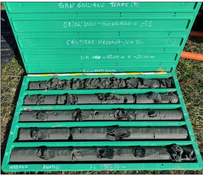
Foto n.4 : Cassetta n.4 sondaggio S1. Carote di terreno da -15.00 a -20.00 m
