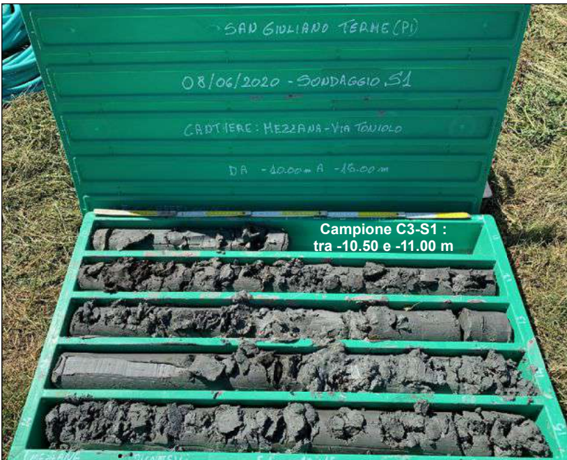
Foto n.3 : Cassetta n.3 sondaggio S1. Carote di terreno da -10.00 a -15.00 m
