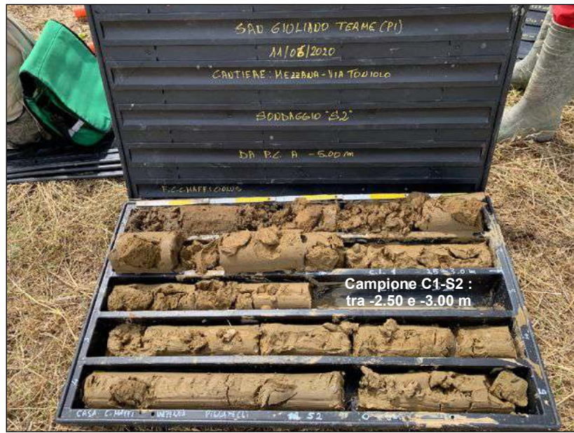
Foto n.1 : Cassetta n.1 sondaggio S2. Carote di terreno da p.c. (0.00 m) a -5.00 m
