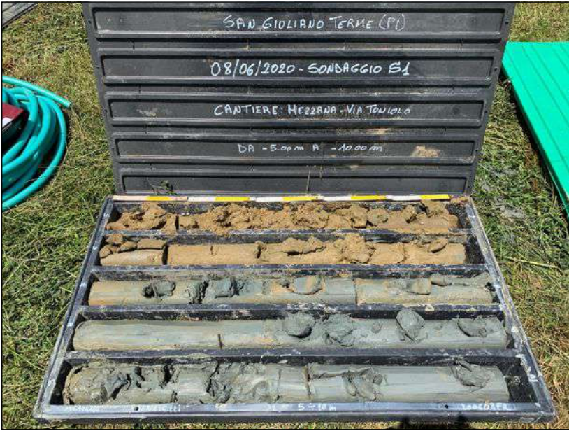
Foto n.2 : Cassetta n.2 sondaggio S1. Carote di terreno da -5.00 a -10.00 m
