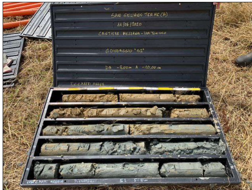
Foto n.2 : Cassetta n.2 sondaggio S2. Carote di terreno da -5.00 a -10.00 m
